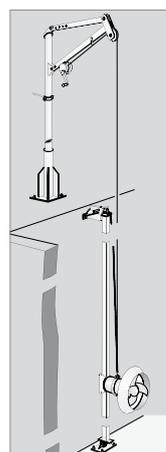
**Montage an Führungsrohr:** Das Rührwerk wird entlang eines Führungsrohrs, das sich an der Behälterwand befindet, gehoben oder gesenkt.
