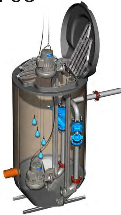
In einer Station mit zwei Pumpen werden gewöhnlich vier Niveauregler eingesetzt. Einer wird als Stoppniveau eingesetzt, einer als Startniveau an jeder der zwei Pumpen und der vierte Regler dient zur Auslösung eines Hochwasseralarms.
