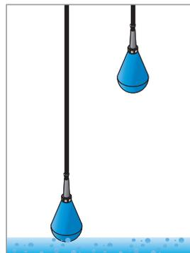
3. Der Pumpvorgang wird beendet, wenn der untere Regler in die vertikale Position zurückkehrt und das Signal zum Anhalten der Pumpe gibt.
